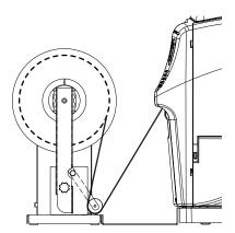
12 Setzen Sie den Druckjob im QL-800 fort. Der Rewinder wickelt das Material bei Bedarf automatisch auf. Der Rewinder stoppt, wenn der Drucker kein Material mehr vortransportiert oder wenn im Drucker kein Material mehr vorhanden ist.
