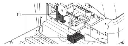
Die Tintenpatronenverriegelungen sind mit Etiketten versehen, die die jeweils zu installierende Farbe anzeigen.
