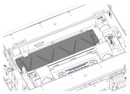
7 Schneiden Sie das Material unter der Einlaufführung sorgfältig ab. Sie können dabei das Material mit einer Schere oder einem Messer anschneiden und den Rest mit der Hand abreißen.
