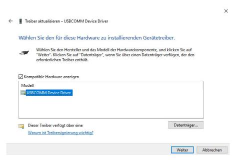
Wählen Sie den **USBCOMM-Gerätetreiber**. Wählen Sie dann **Weiter** und führen Sie die auf dem Bildschirm angegebenen Anweisungen aus, um diesen Vorgang durchzuführen.
