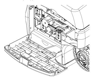
Öffnen Sie die Tintenpatronenverriegelung der leeren Patrone. Die Verriegelung lässt sich öffnen, indem Sie von oben auf den Verriegelungsmechanismus drücken und die Verriegelung herausziehen.
