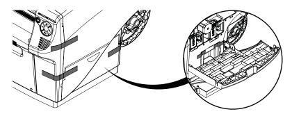
7 Entfernen Sie bei geöffneter Hauptklappe die gelbe Transportsicherung der Transporteinheit, indem Sie diese ca. 45° gegen den Uhrzeigersinn drehen, ausrichten und dann in einer geradlinigen Bewegung herausziehen. Bewahren Sie die Transportsicherung für einen späteren Transport des Geräts auf.
