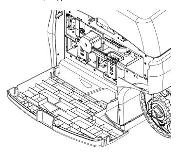
Fassen Sie die Transporteinheit am Griff an. Ziehen Sie die Transporteinheit dann in einer geradlinigen Bewegung aus dem Drucker heraus.
