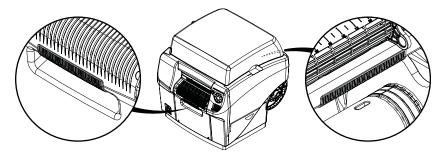
Der Drucker sollte wie im Folgenden dargestellt waagerecht auf den Winkeln positioniert sein. Die Vorderseite des Druckers sollte an der hochgebogenen Lasche des Winkels anliegen.
