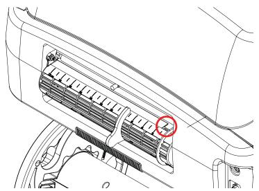
Falls Klebstoffreste vorhanden sind, reinigen Sie die betroffenen Bereiche mit einem Wattestäbchen, das Sie vorher mit Isopropylalkohol angefeuchtet haben.
