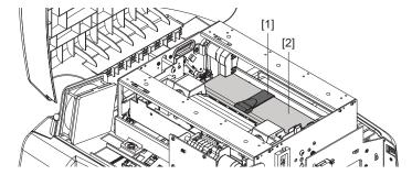
Nehmen Sie den Schaumstoffblock [2] aus dem Drucker heraus. Gehen Sie beim Herausnehmen des Blocks vorsichtig vor, um zu vermeiden, dass sich die Wartungswalzeneinheit verschiebt.
