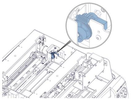
6) Überprüfen Sie die Laufrollen an der Druckengine. Vergewissern Sie sich, dass beide Rollen vorhanden sind.
