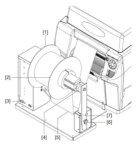
2 Drehen Sie die Schraube [6] entgegen dem Uhrzeigersinn, um den Rollentragarm [7] zu lösen und abzunehmen.
