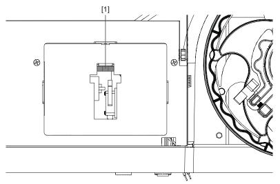
Reinigen Sie mit einem sauberen, fusselfreien und mit Isopropylalkohol angefeuchtetem Tuch den im Folgenden markierten Bereich der Wartungspatrone.
