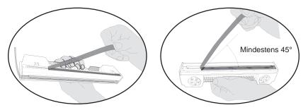
**Vorsicht:** Entsorgen Sie die entfernten Kunststoffstreifen sofort und achten Sie darauf, dass die Streifen nicht mit den elektrischen Kontakten oder den Druckkopfdüsen in Berührung kommen.
