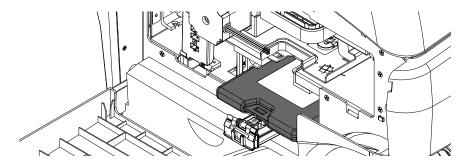
4 Schließen Sie die Tintenpatronenverriegelungen. Schließen Sie danach die seitliche Hauptklappe.
