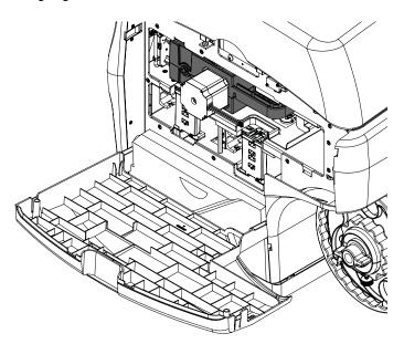
Anmerkung: Falls die gelbe Transportsicherung der Transporteinheit installiert ist, können Sie die Einheit nicht herausnehmen. Sie müssen zunächst die Transportsicherung entfernen, indem Sie diese gegen den Uhrzeigersinn drehen und dann in einer geradlinigen Bewegung herausziehen. Diese Sicherung wird üblicherweise während des Auspackens entfernt.
