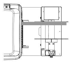
Verschieben Sie den Unwinder in den Ausrichtschlitzen so weit nach links bzw. rechts, bis das Material rechtwinklig zur feststehenden Führung ausgerichtet ist. Ziehen Sie dann die Schrauben fest.
