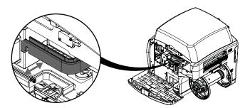
Über der Transporteinheit befindet sich für den Versand ein feuchtigkeitsabsorbierendes Kissen. Entfernen Sie dieses Kissen.
