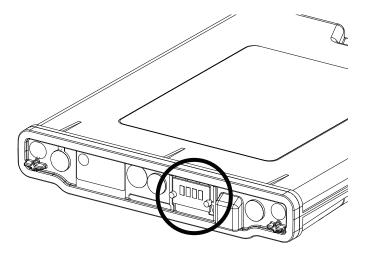
7 Benutzen Sie ein ebenfalls mit Isopropylalkohol angefeuchtetes Wattestäbchen, um die Anschlusskontakte für die Tintenpatronen im Drucker zu reinigen.
