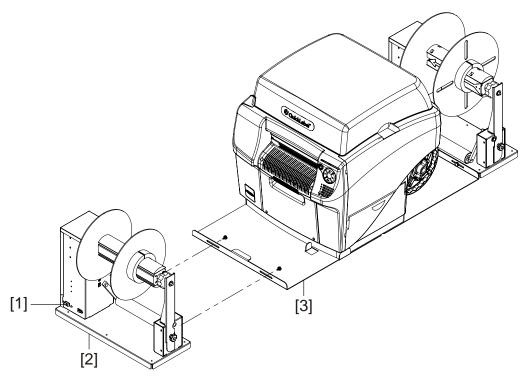
**Anmerkung:** Die folgenden Anleitungen gehen davon aus, dass Sie sowohl den optionalen Rewinder als auch den externen Unwinder verwenden. Falls Sie nur den Rewinder benutzen, unterscheidet sich der Installationsvorgang. Siehe "Installation des Rewinders" auf Seite 154.
