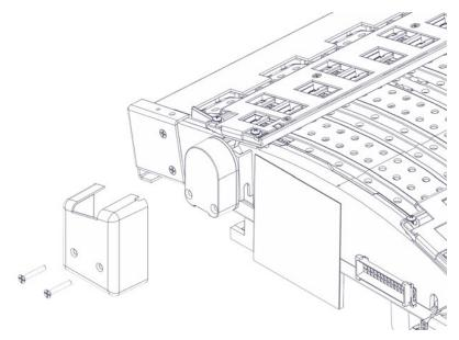
**Anmerkung:** Gehen Sie bei Arbeiten in der Nähe der Encoderscheibe äußerst vorsichtig vor. Die Encoderscheibe ist ein empfindliches Bauteil, das durch Schmutz, Kratzer usw. beschädigt werden kann.
