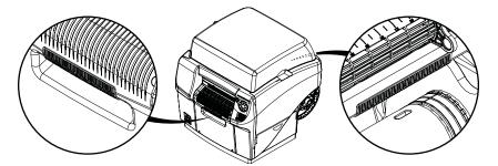
Der Drucker verfügt über Gummifüße, die zum sicheren Stand des Geräts beitragen und unabsichtliche Bewegungen verhindern. Wenn Sie den Drucker am Aufstellort verschieben möchten, heben Sie ihn bitte leicht an. Das Ziehen des Druckers könnte zur Beschädigung der Gummifüße führen.
