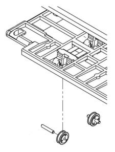
e) Bauen Sie die betreffende Sternradbaugruppe wieder ein, indem Sie die vier Schrauben anziehen. Vergewissern Sie sich, dass die Sternradkonsole gerade und korrekt ausgerichtet ist.
