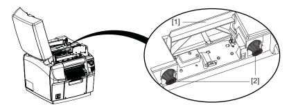
**Anmerkung:** Die Druckkopfverriegelung befindet sich in der geöffneten Stellung. Schließen Sie die Verriegelung nicht vor der Installation des Druckkopfs. Falls die Verriegelung versehentlich geschlossen wird, versuchen Sie nicht, sie mit Gewalt zu öffnen. Schalten Sie den Drucker aus und wieder ein. Die Verriegelung öffnet sich beim Einschalten automatisch, wenn kein Druckkopf installiert ist.
