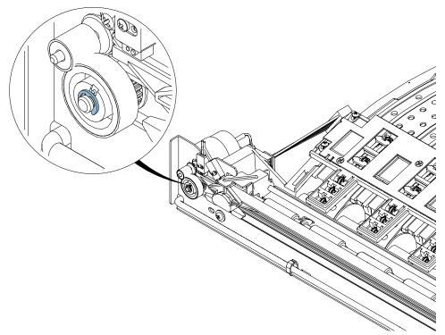
5) Vergewissern Sie sich, dass der Schnitt durch das Linermaterial zwischen den Etiketten erfolgt. Stellen Sie gegebenenfalls die Schnitt-/Stop-Position unter der Registerkarte "Druckeinstellungen" des QL-800-Wartungsprogramms neu ein.
