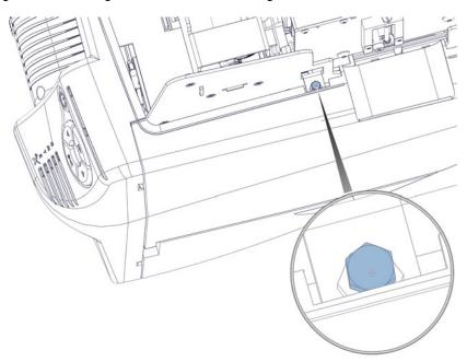
3) Falls die obere Abdeckung geschlossen ist und der Fehler weiterhin anliegt, vergewissern Sie sich, dass der Türschalter beim Schließen der Abdeckung betätigt wird. Biegen Sie den Schalterhebel gegebenenfalls etwas nach oben.
