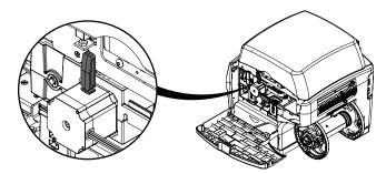
**Anmerkung:** Der Drucker funktioniert auch mit eingebauter Transportsicherung. Die Transporteinheit kann bei eingebauter Transportsicherung jedoch nicht entfernt werden.
