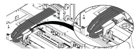
**Vorsicht:** Falls die Tinte nicht in allen Röhrchen sichtbar ist, wenden Sie sich bitte an unseren Technischen Support. Führen Sie den "Nach dem Versand"-Assistenten im QL-800-Wartungsprogramm NICHT noch einmal aus, da dies zu einem Tintenüberlauf führen könnte.
