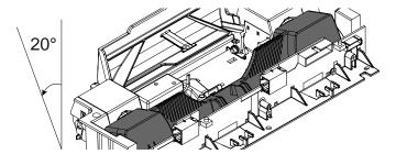
**Vorsicht:** Vermeiden Sie jeglichen Kontakt mit der Druckkopf-Anschlussplatine im Inneren des Druckers.
